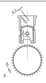
RELEASE THE FEELER GAUGE AND TURNING COUNTERCLOCKWISE LOWER THE PISTON TO ALLOW THE INSERTION OF THE FEELER UNDER THE UPPER EDGE OF THE EXHAUST.
