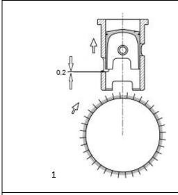
TURN CLOCKWISE AND LIFT THE PISTON TO ALLOW THE INSERTION OF THE FEELER GAUGE AGAINST THE LOWER EXHAUST EDGE.
